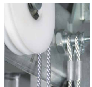
Absturzsicherheit durch doppelte Seilzüge
